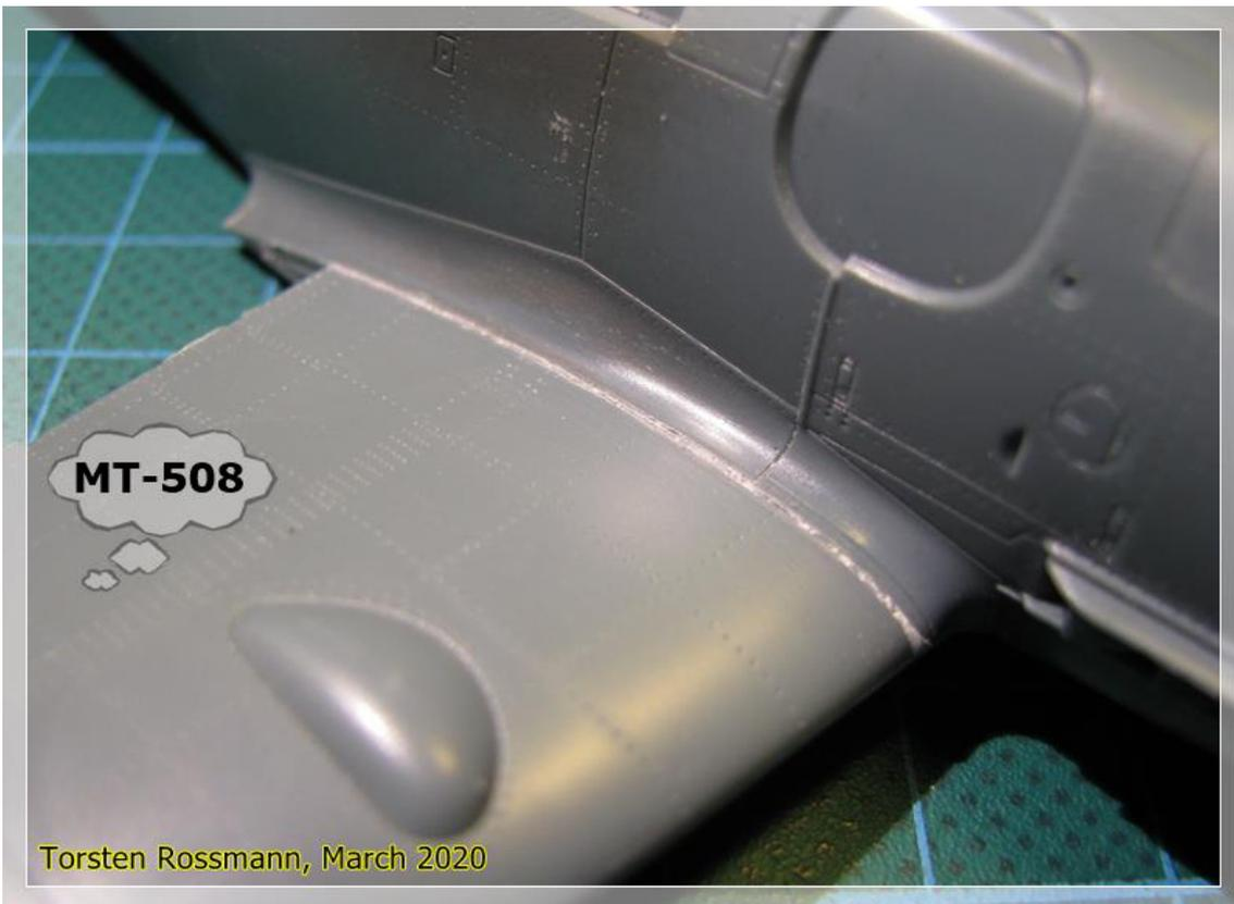
aufgefüllt werden konnte, mußte ich auf der rechten Seite spachteln. Dank Tesafilm auf beiden Seiten des Spaltes blieb nach dem Schleifen und Polieren nur eine kleine Naht übrig. Die Gravuren wurden nicht beschädigt.
