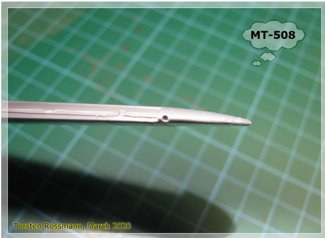
Unnötig ist das bereits an der Tragfläche angegossene Staurohr, was während der Bastelarbeiten garantiert abbrechen wird. Ich schnitt es kurzerhand ab und bohrte ein kleines Loch, da Eduard mit dem Teil I 21 bereits ein Ersatzteil mitliefert.
